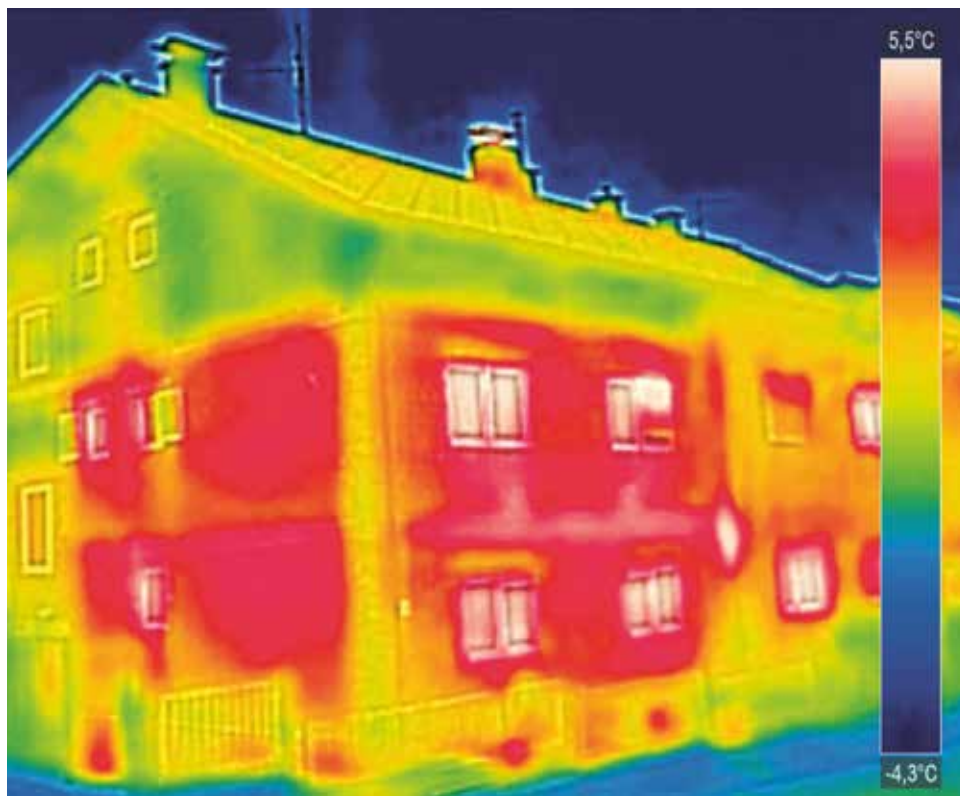
EIN WÄRMEBILD ZEIGT ANSCHAULICH, WO WÄRME VERLOREN GEHT.
